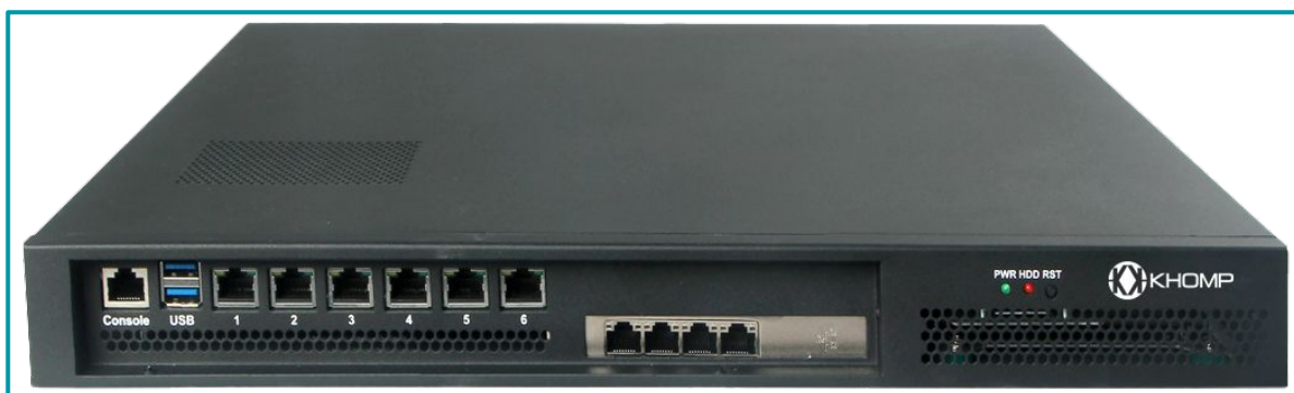
Legenda: Visão superior e frontal com placa de rede adicional 4 x LAN.
